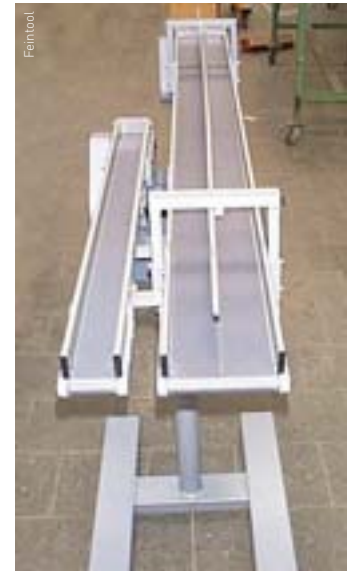
Das Förderband sortiert NIO-Teile (Nicht-in-Ordnung-Teile) und IO-Teile (In-Ordnung-Teile).
